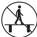
Nie stosować drabiny jako mostu Do not use the ladder as a bridge
