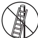
Upewnić się, że wierzchołek drabiny jest ustawiony właściwie Ensure top of ladder is correctly positioned
