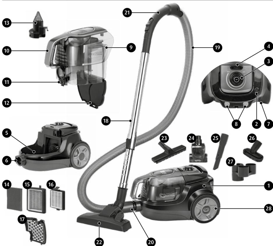
*Пылесос без мешка для пыли (циклонный), в отличие от классического пылесоса, имеет специально разработанный отсек, в котором загрязненный воздух совершает движение по кругу с очень большой скоростью, в результате чего центробежная сила выбрасывает все загрязнения в пылесборник. Пылесборник очень легко очистить от пыли, благодаря чему использование пылесоса позволяет экономить время, а также снизить эксплуатационные расходы.*
