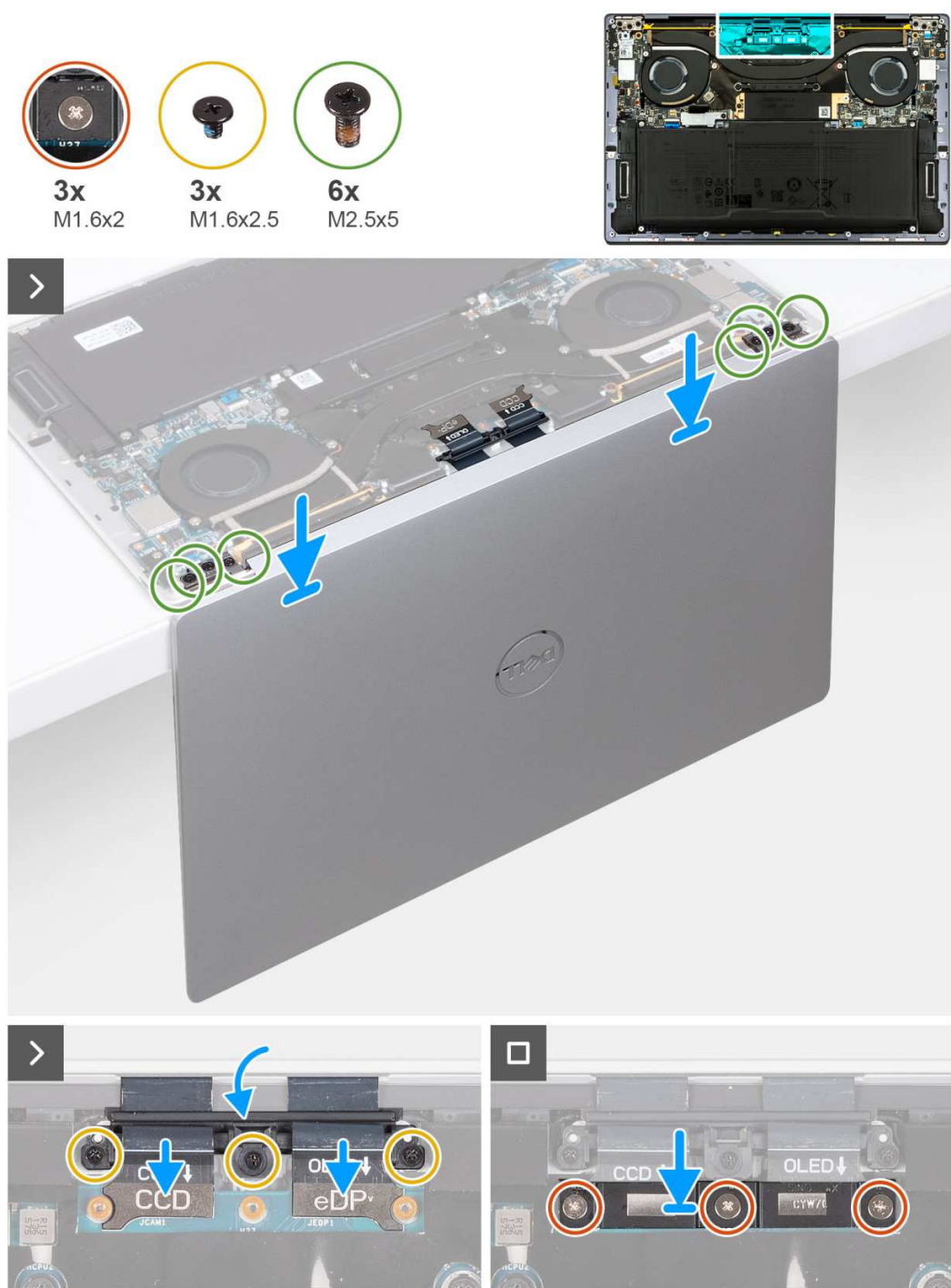
Rysunek 36. Instalowanie zestawu wyświetlacza
