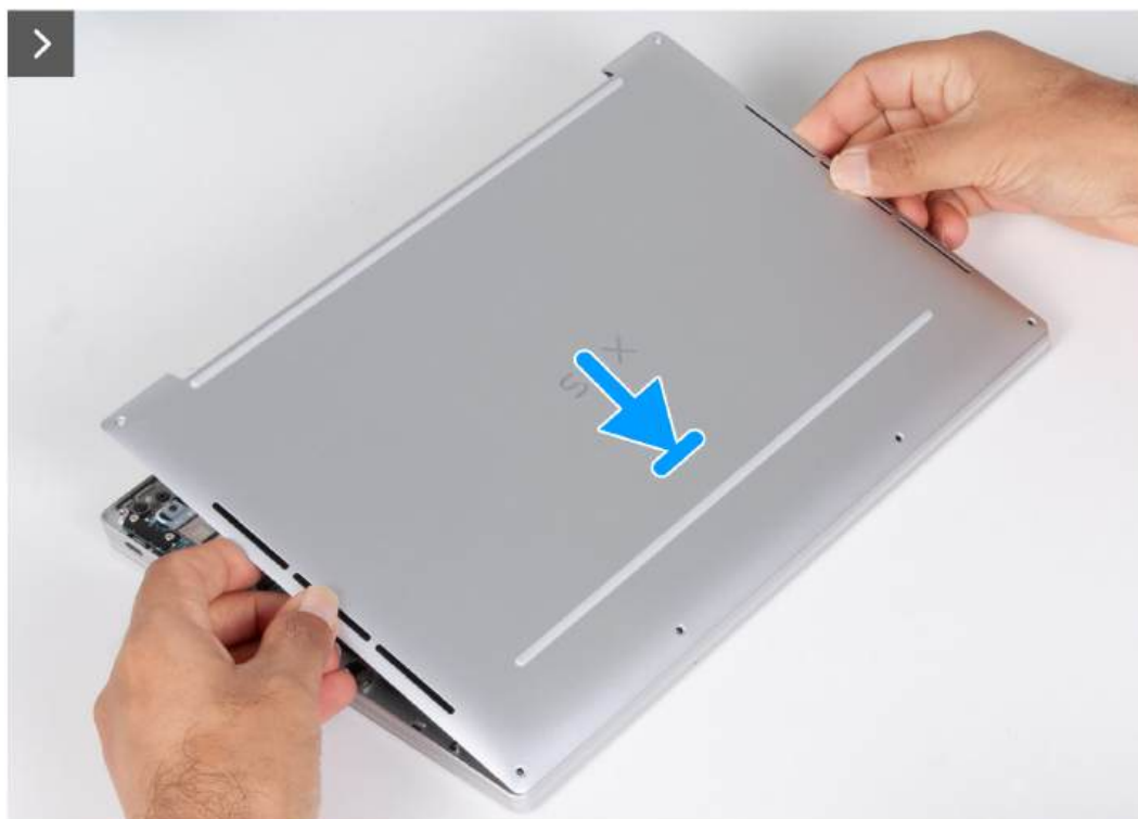
Rysunek 17. Instalowanie pokrywy dolnej
