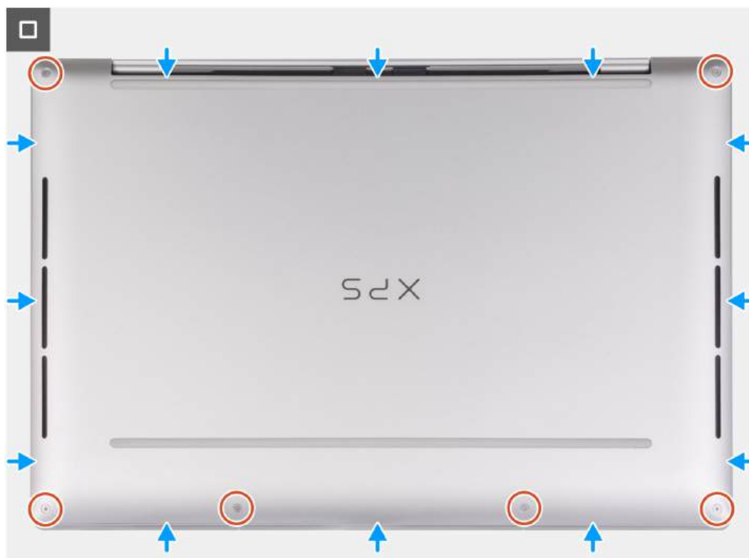
Rysunek 18. Instalowanie pokrywy dolnej
