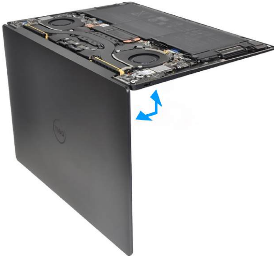
Rysunek 48. Otwieranie zestawu wyświetlacza pod kątem 90 stopni
