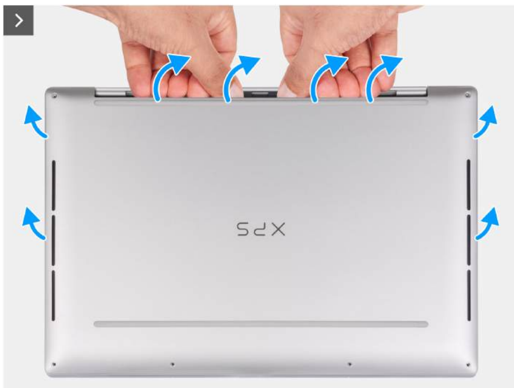
Rysunek 15. Wymontowywanie pokrywy dolnej
