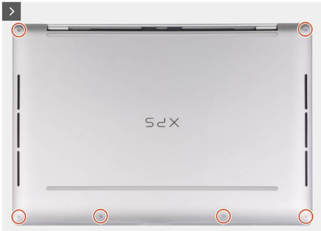
Rysunek 14. Wymontowywanie pokrywy dolnej
