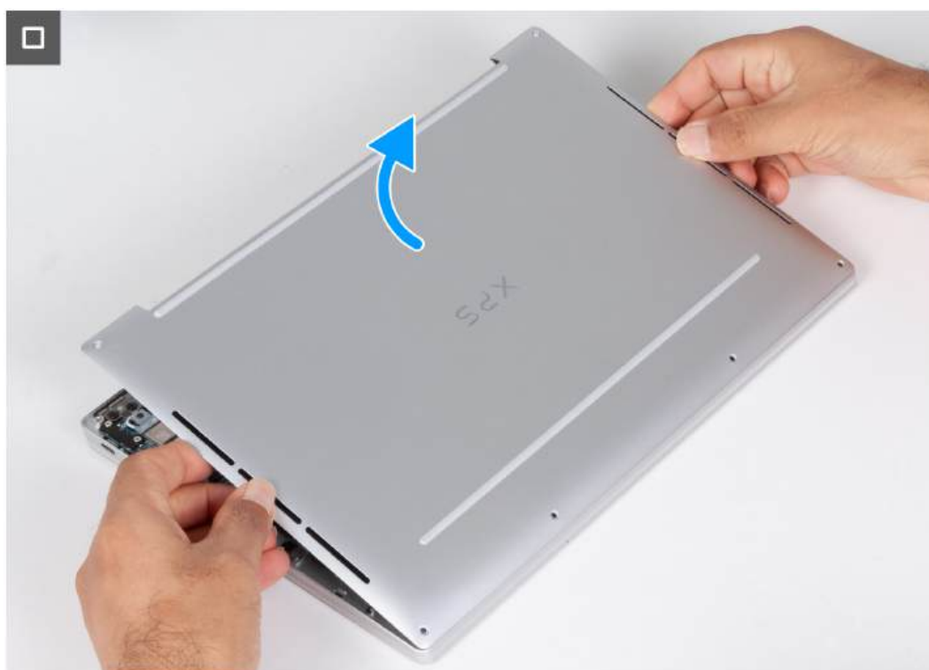
Rysunek 16. Wymontowywanie pokrywy dolnej
