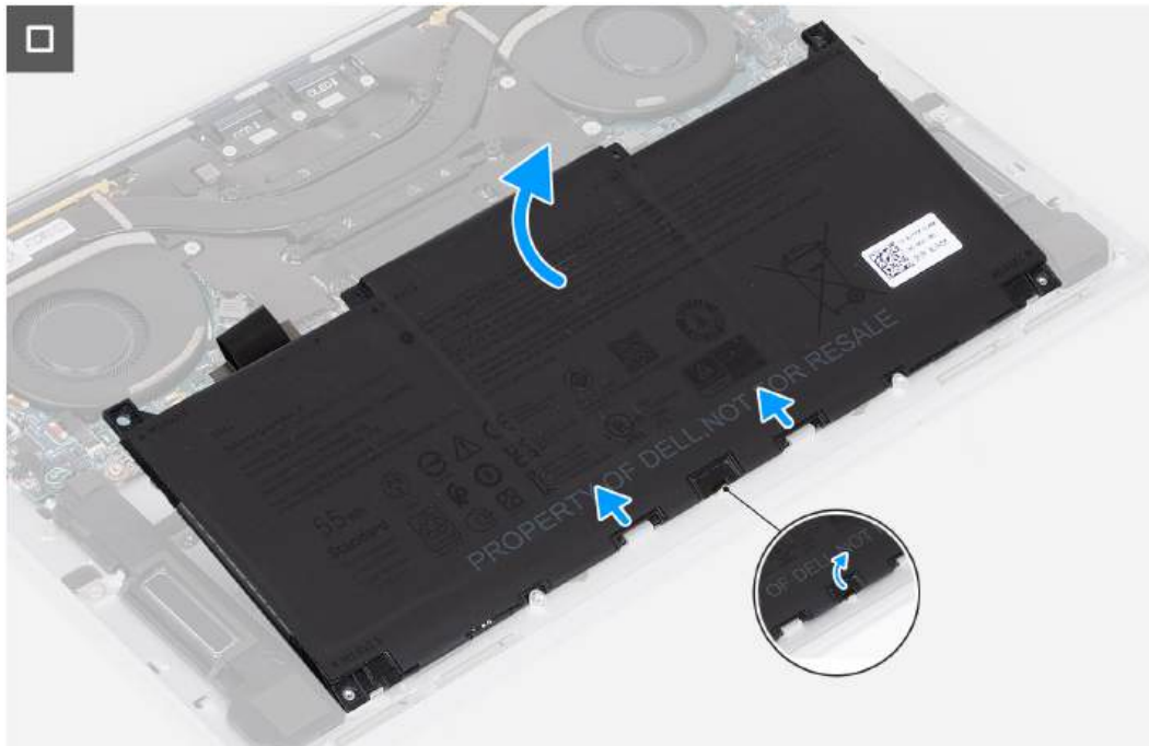
Rysunek 20. Wymontowywanie baterii
