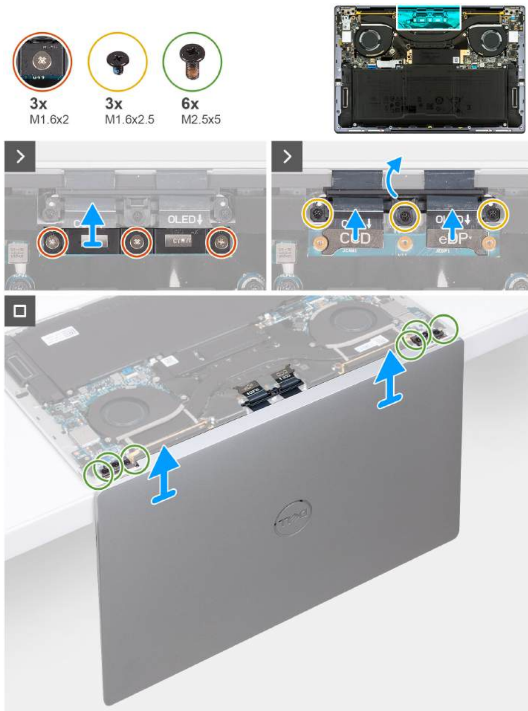
Rysunek 35. Wymontowywanie zestawu wyświetlacza
