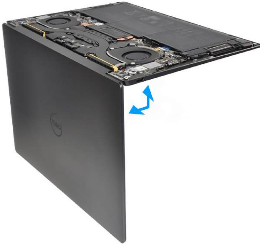
Rysunek 40. Otwieranie zestawu wyświetlacza pod kątem 90 stopni
