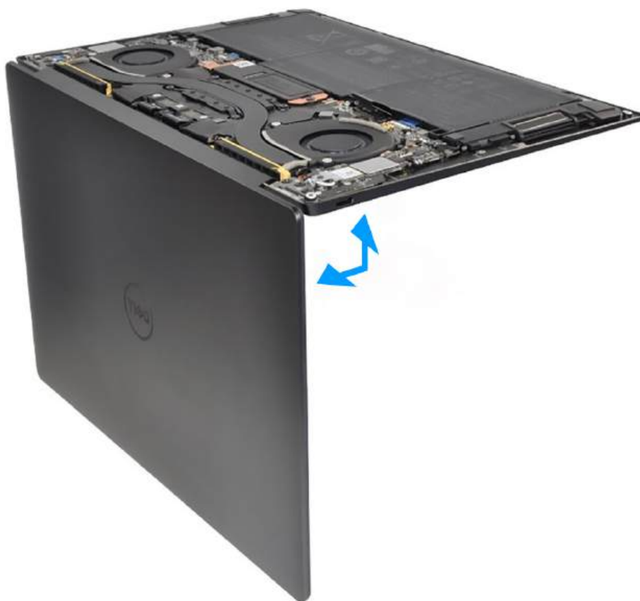
Rysunek 44. Otwieranie zestawu wyświetlacza pod kątem 90 stopni
