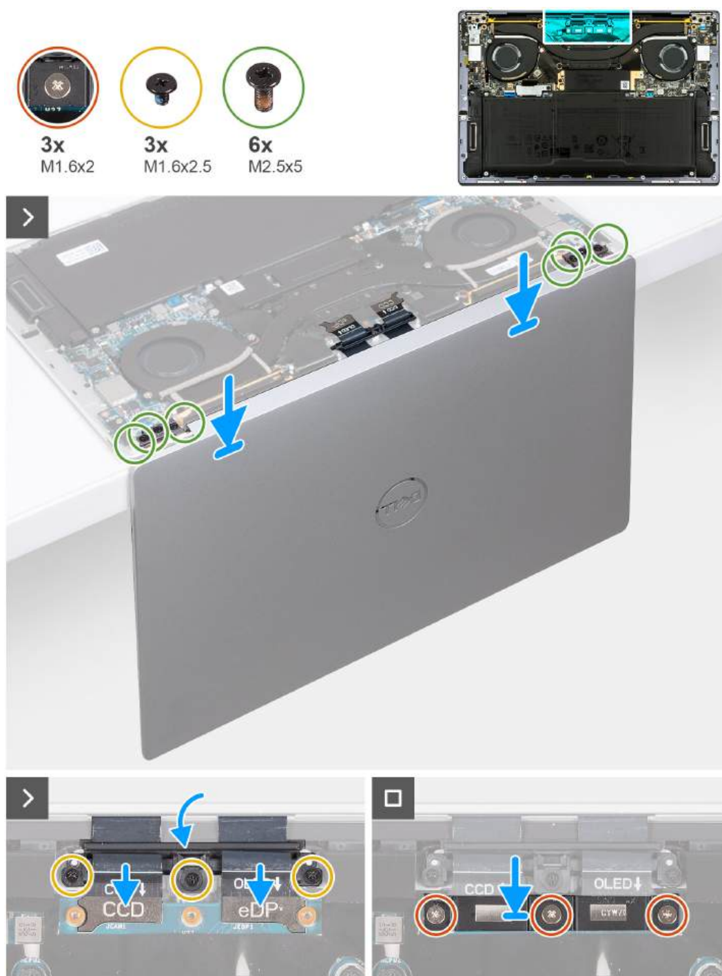
Rysunek 36. Instalowanie zestawu wyświetlacza
