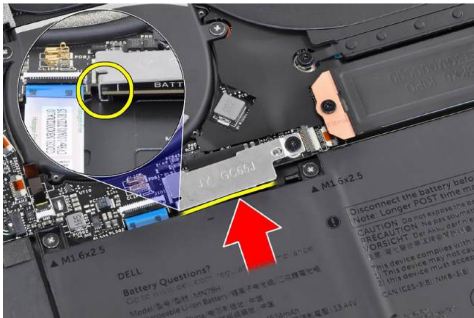
Rysunek 21. Klamra złącza baterii
