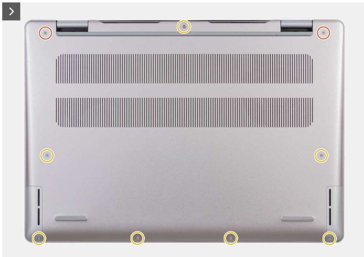
Rysunek 9. Wymontowywanie pokrywy dolnej
