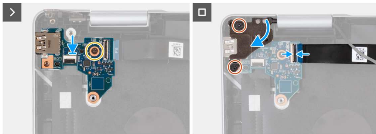
Rysunek 45. Instalowanie płyty we/wy
