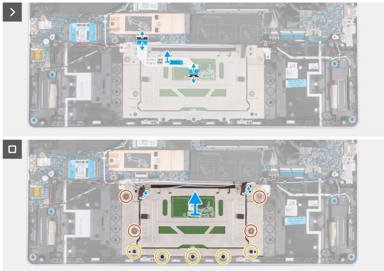
Rysunek 60. Wymontowywanie touchpada
