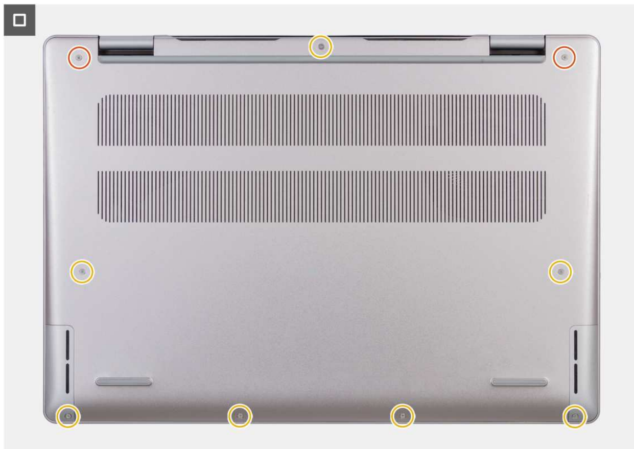
Rysunek 12. Instalowanie pokrywy dolnej
