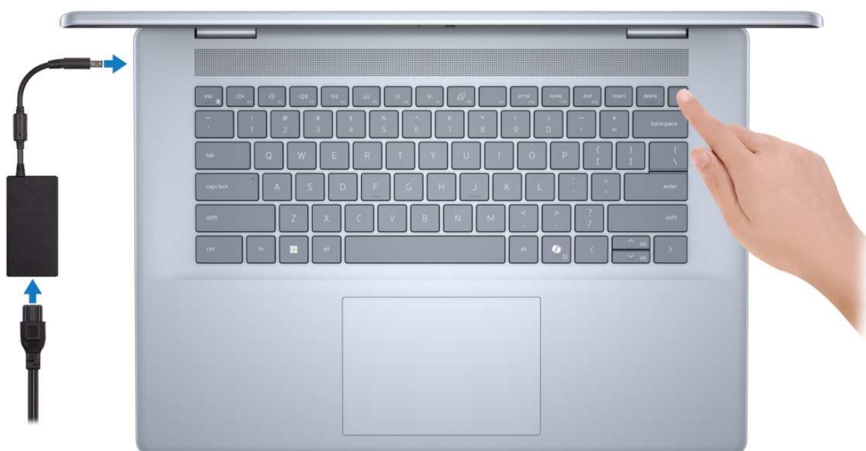
Rysunek 7. Podłącz zasilacz
