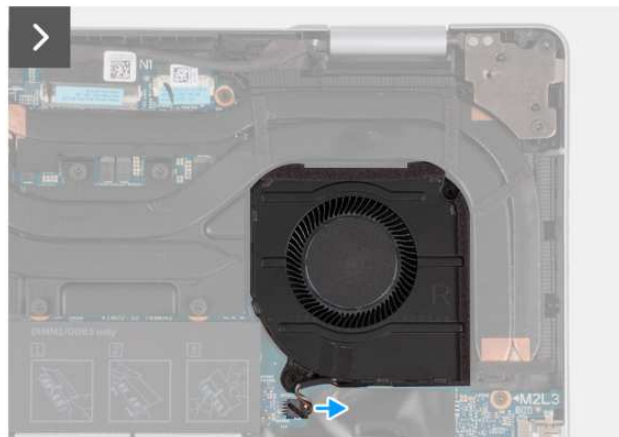
Rysunek 23. Wymontowywanie wentylatora procesora
