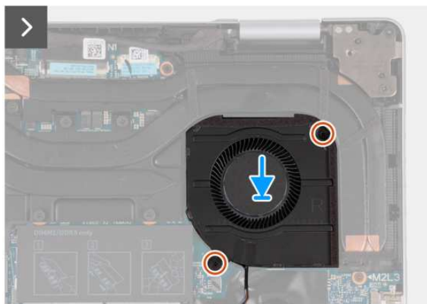
Rysunek 24. Instalowanie wentylatora procesora
