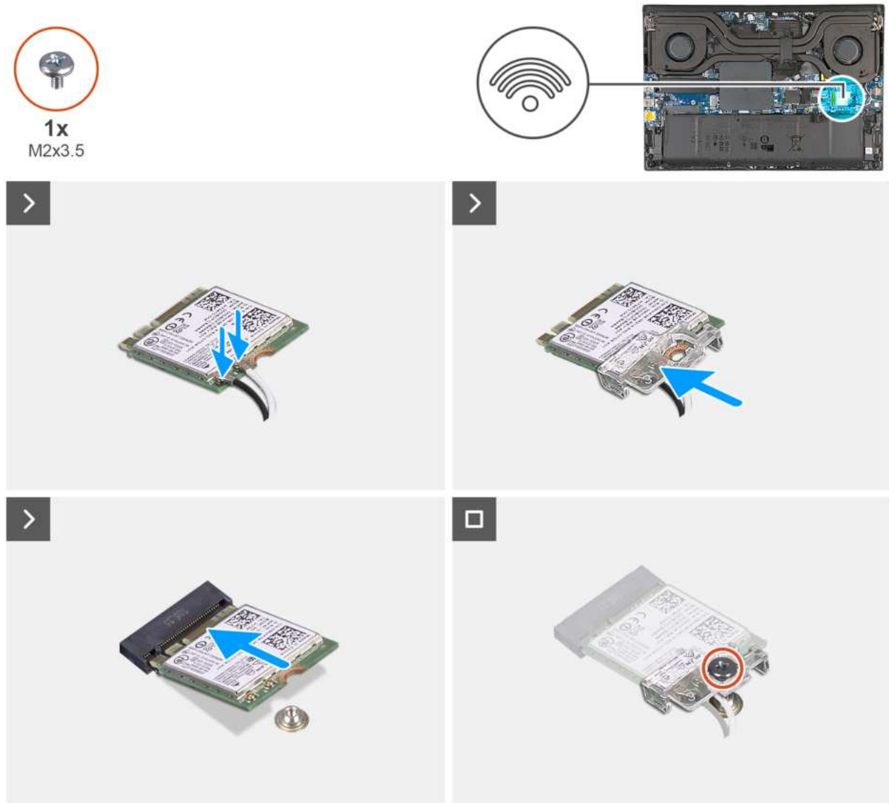
Rysunek 18. Instalowanie karty sieci bezprzewodowej
