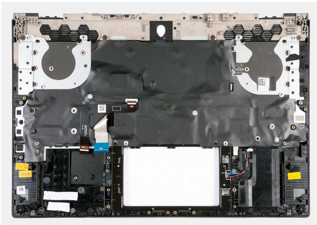
Rysunek 54. Instalowanie zestawu podpórki na nadgarstek i klawiatury
