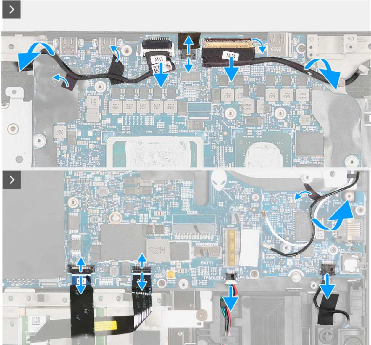
Rysunek 42. Wymontowywanie płyty głównej
