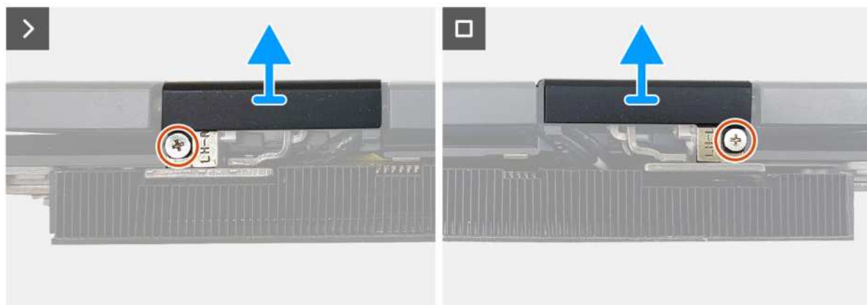
Rysunek 35. Wymontowywanie pokryw zawiasów wyświetlacza
