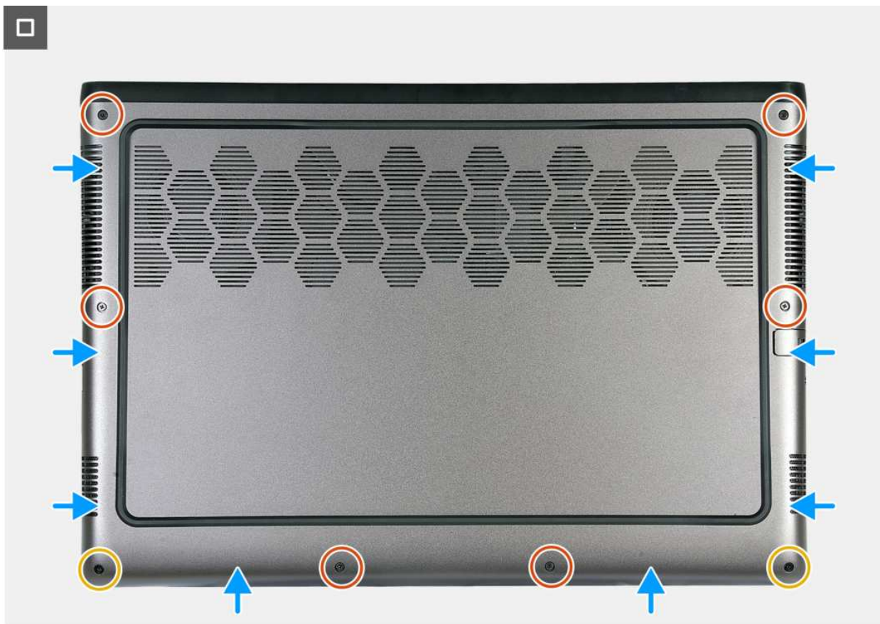
Rysunek 12. Instalowanie pokrywy dolnej
