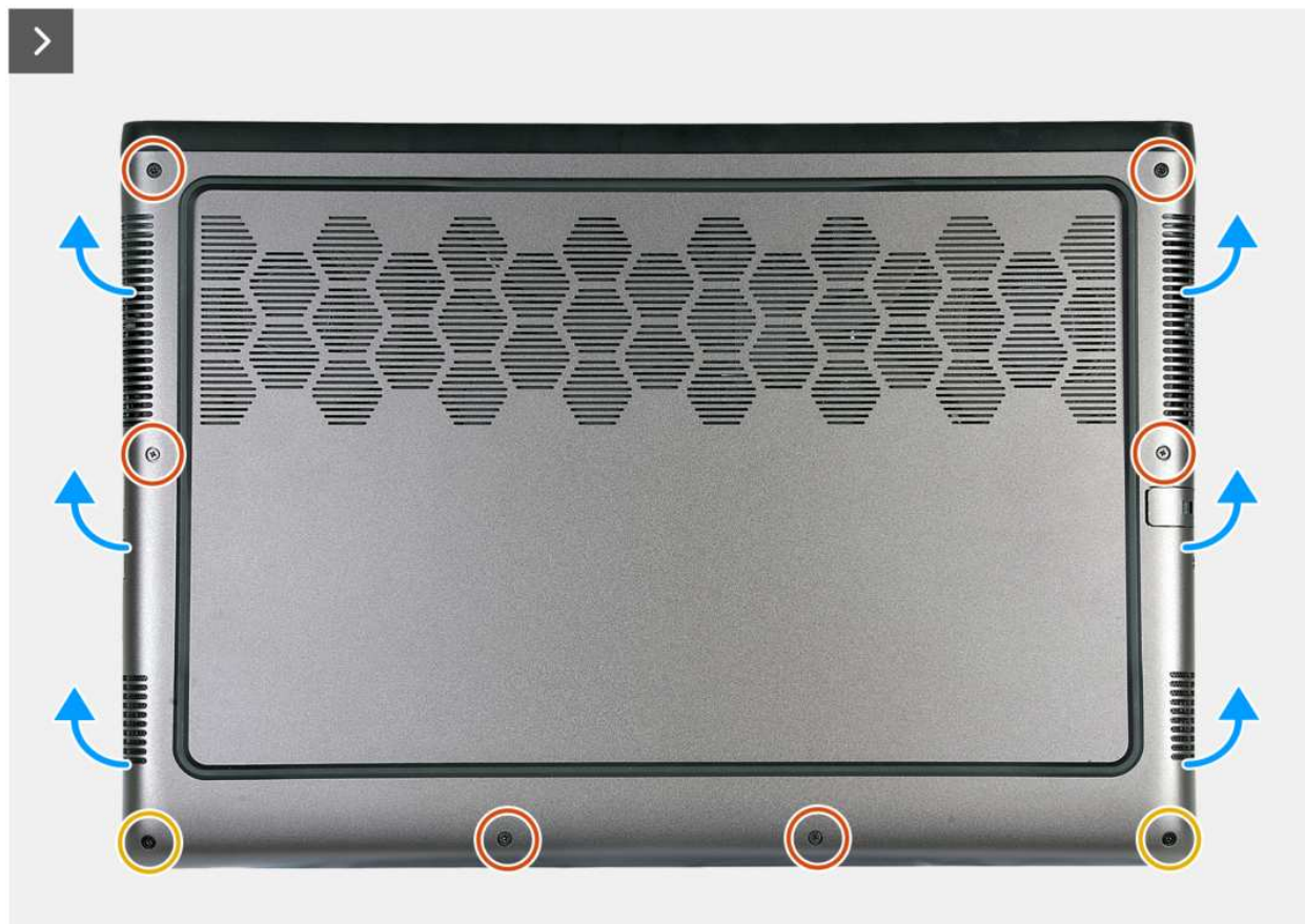
Rysunek 9. Wymontowywanie pokrywy dolnej
