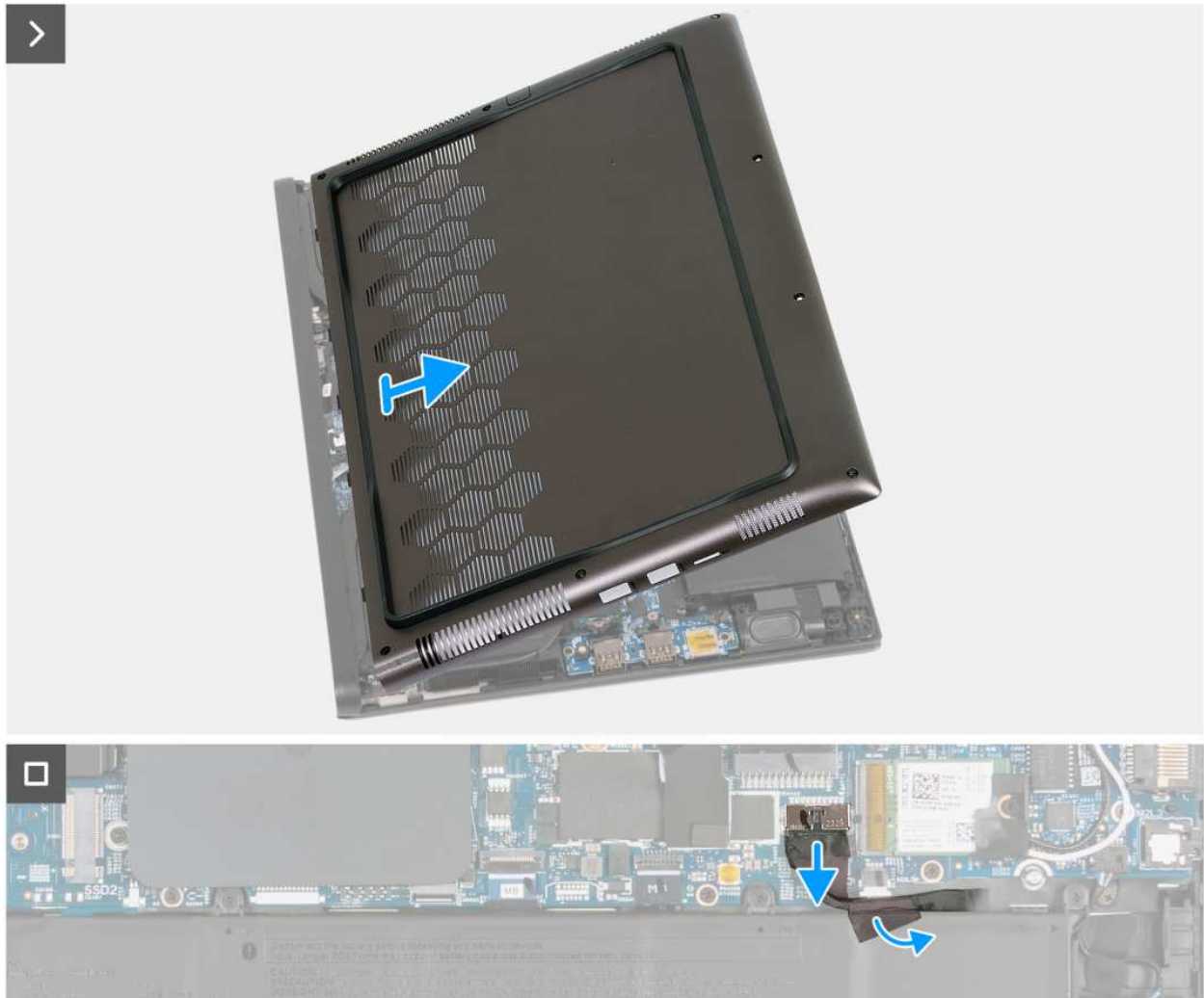
Rysunek 10. Wymontowywanie pokrywy dolnej
