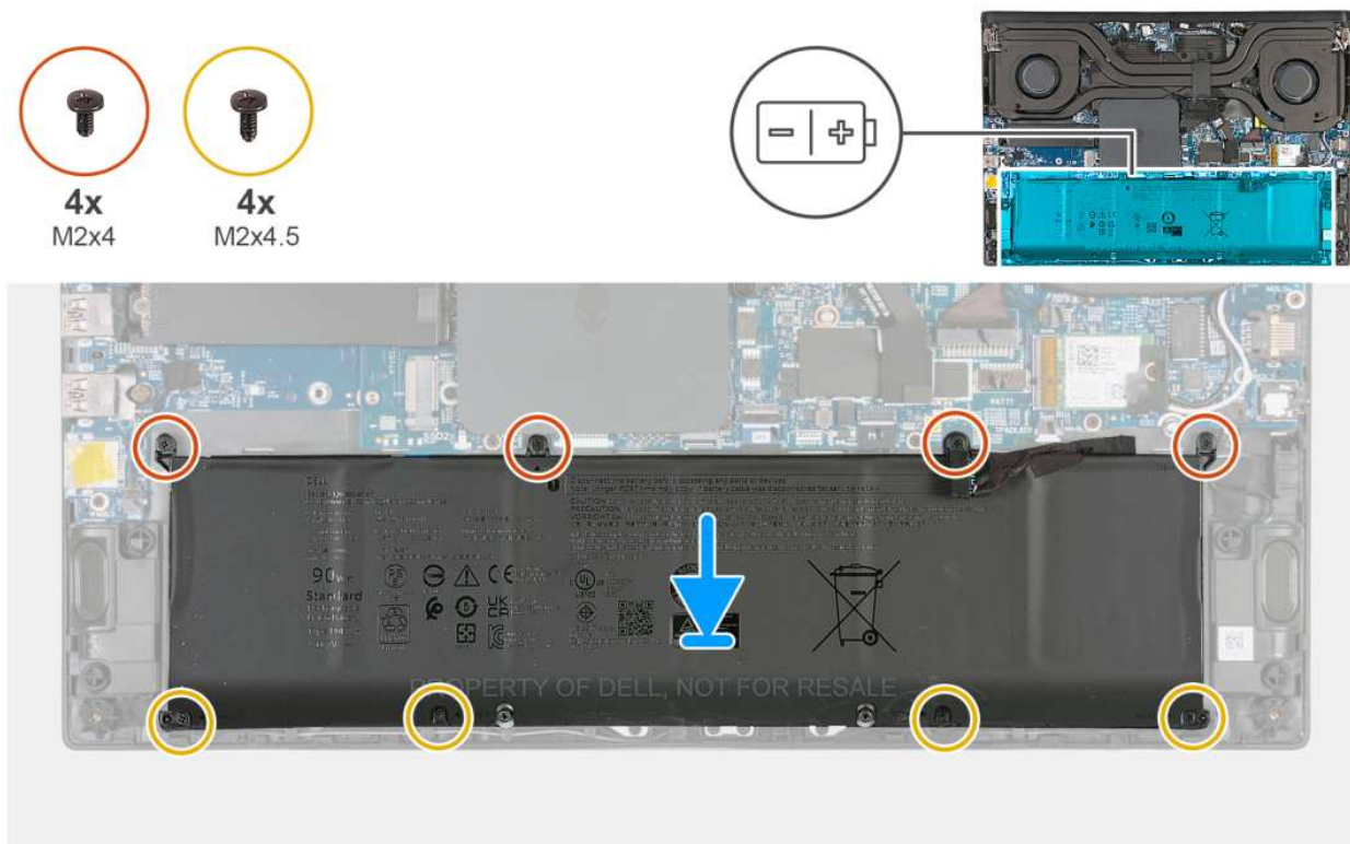
Rysunek 20. Instalowanie baterii
