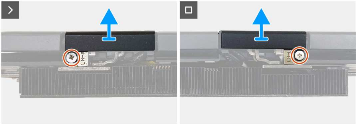
Rysunek 35. Wymontowywanie pokryw zawiasów wyświetlacza
