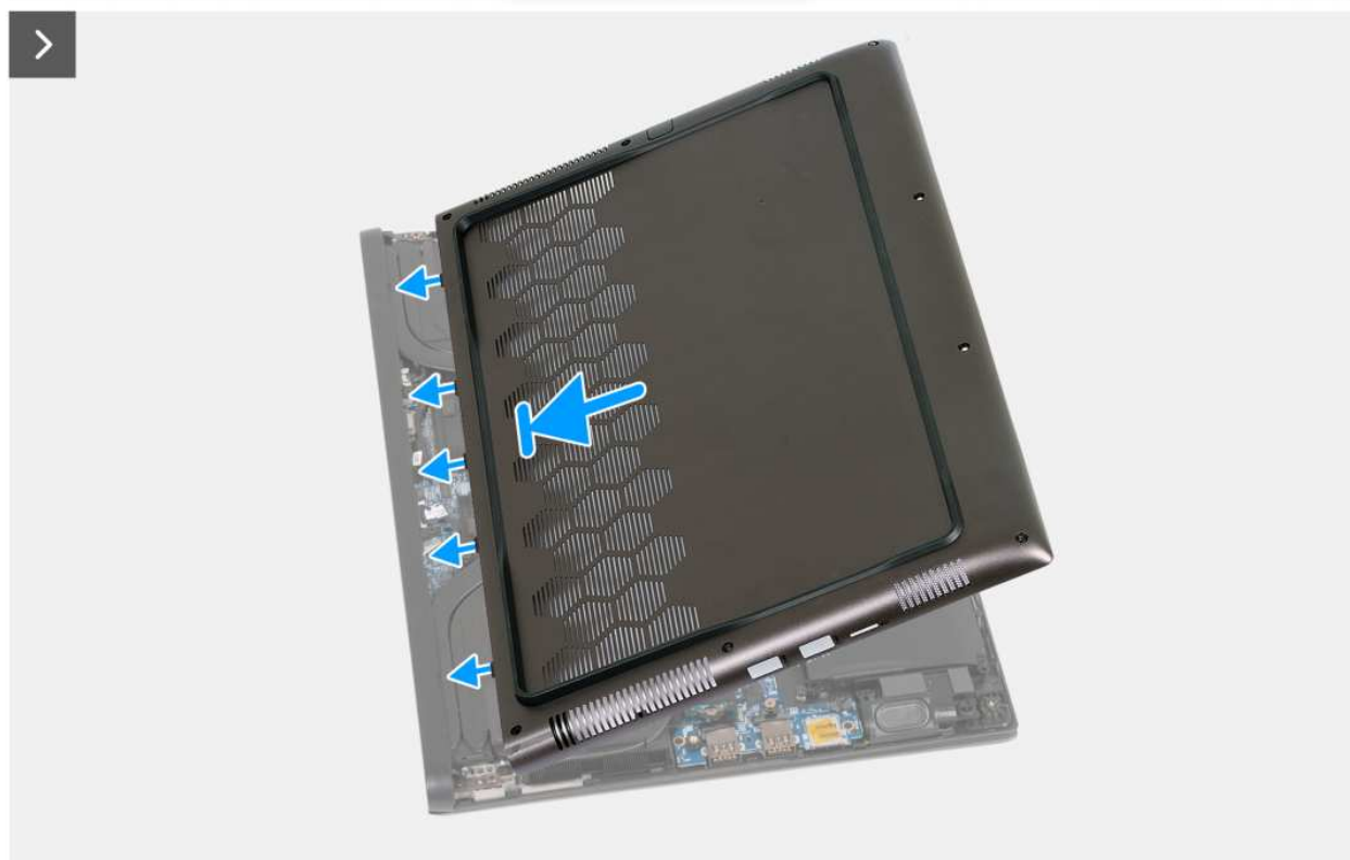
Rysunek 11. Instalowanie pokrywy dolnej
