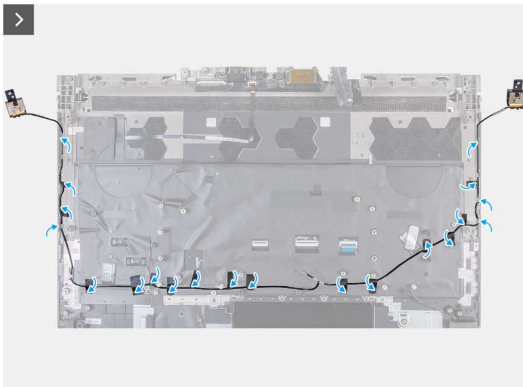
Rysunek 47. Instalowanie anten
