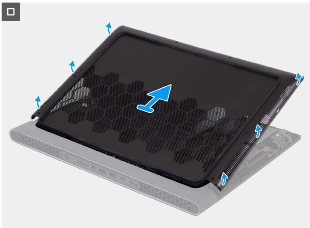
Rysunek 9 Wymontowywanie pokrywy dolnej 38 Wymontowywanie i instalowanie modułów wymienianych samodzielnie przez klienta (CRU)
