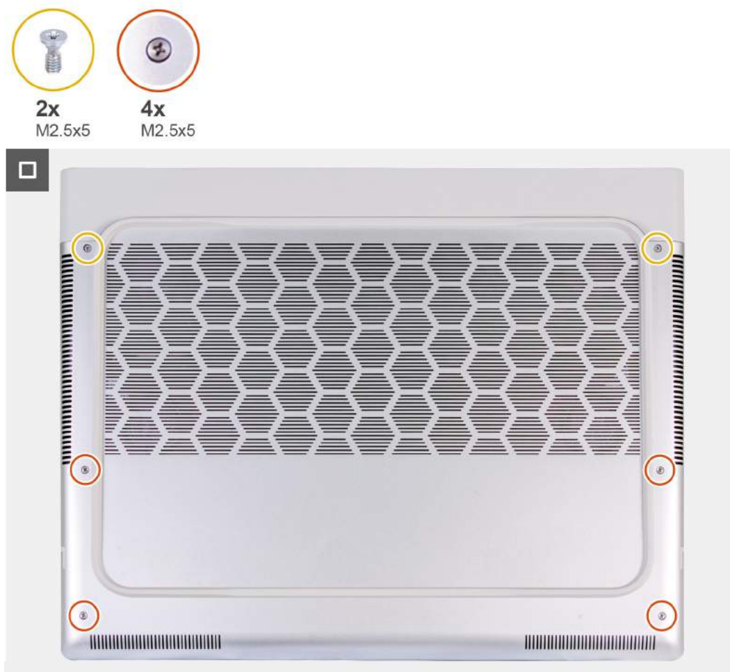
Rysunek 14. Dokręcanie śrub mocujących
