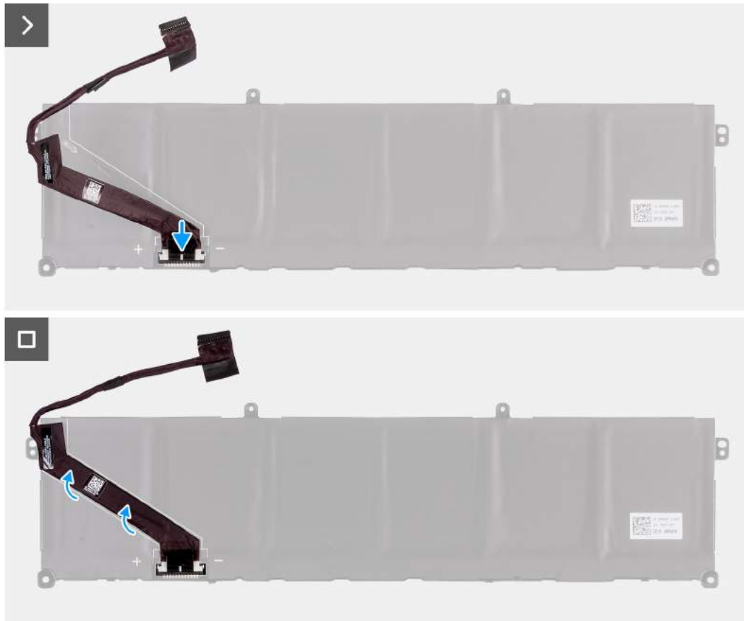
Rysunek 34. Instalowanie kabla baterii
