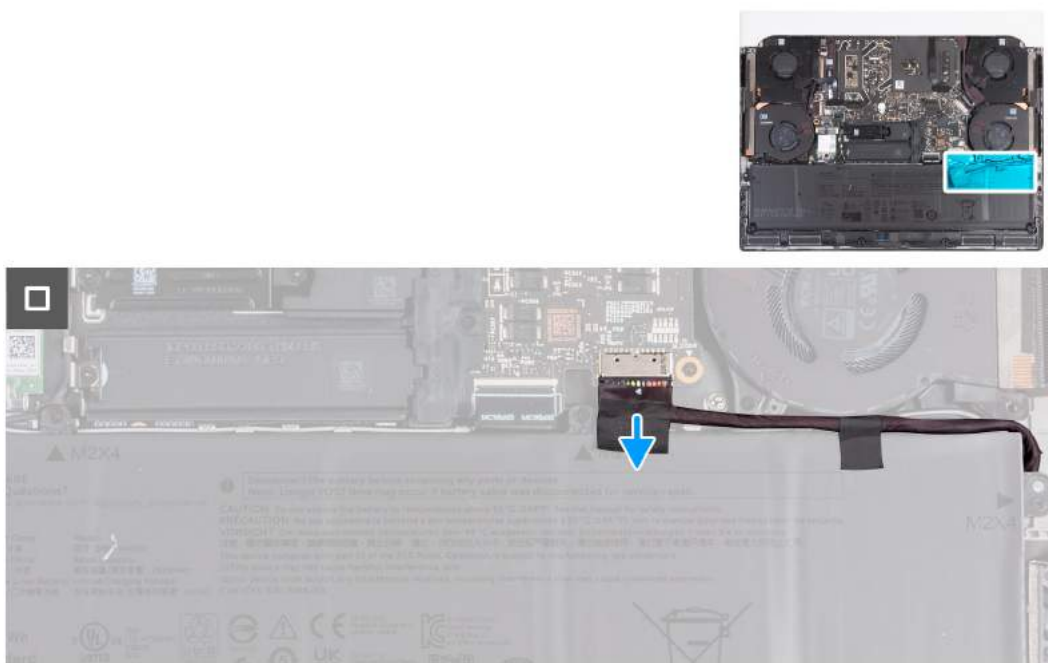
Rysunek 11. Odłączanie kabla baterii
