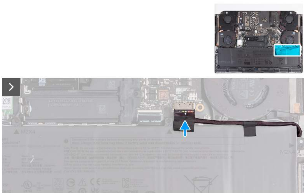
Rysunek 12. Podłączanie kabla baterii
