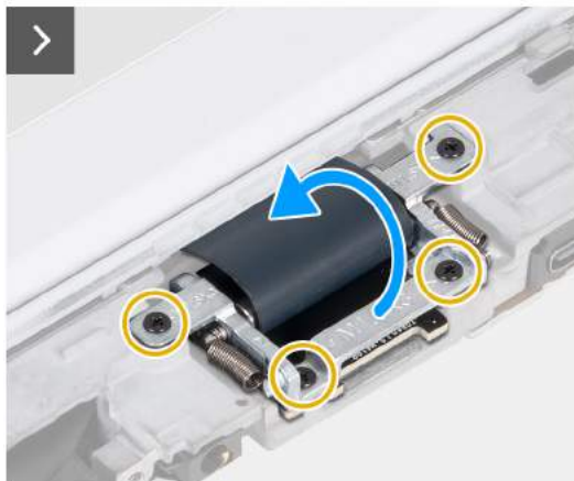
Rysunek 45. Wymontowywanie czytnika kart microSD
