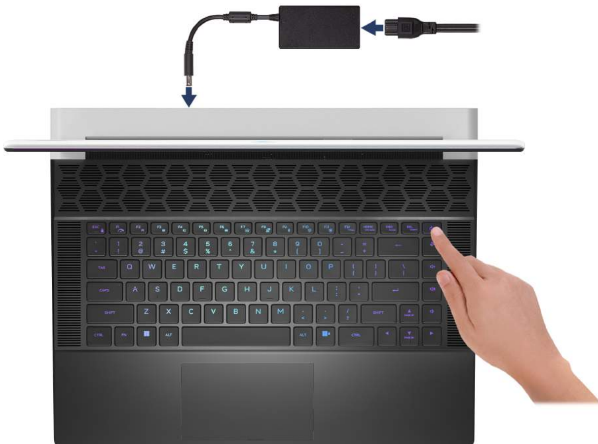
Rysunek 6. Podłącz zasilacz i naciśnij przycisk zasilania
