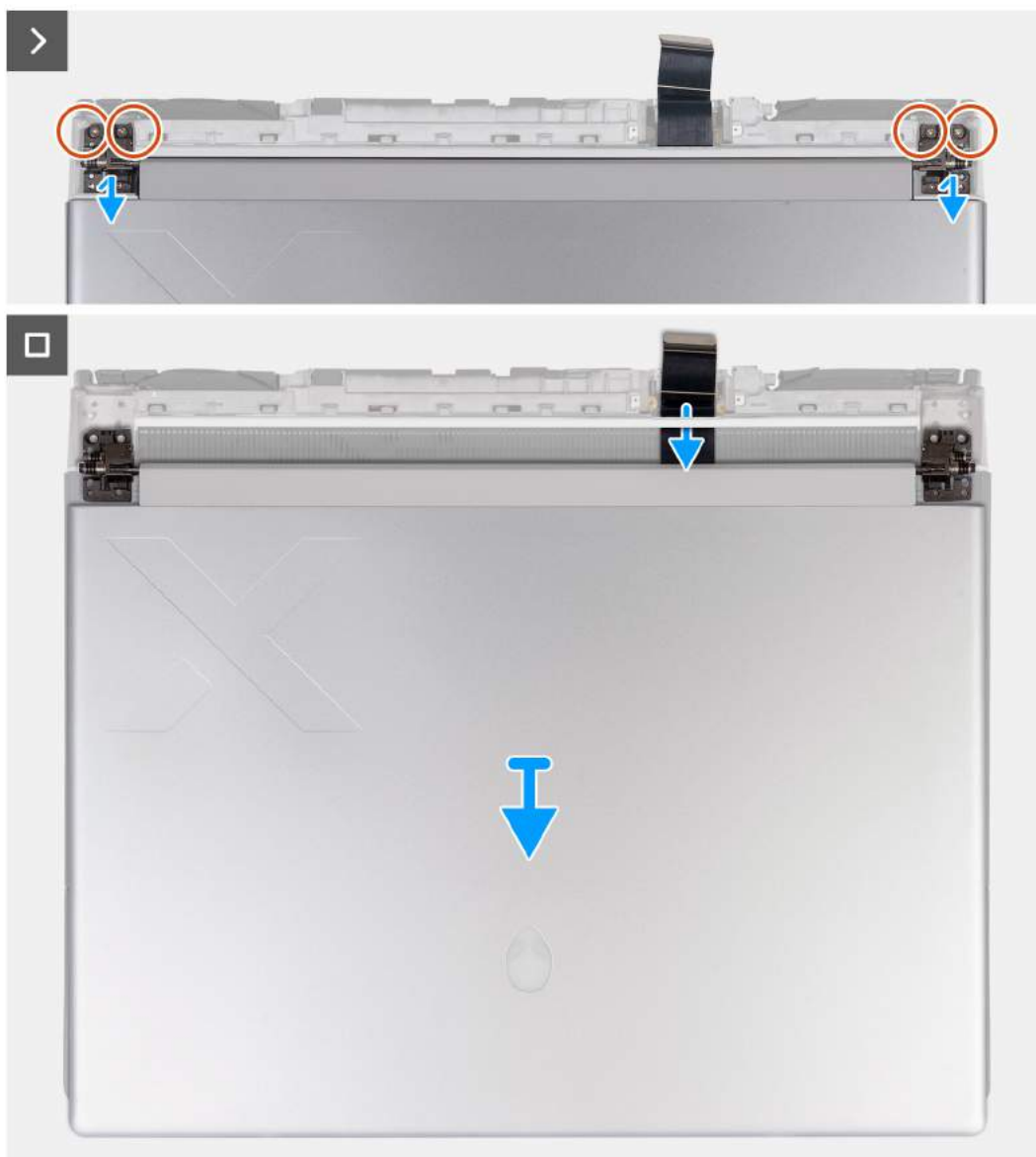
Rysunek 52. Wymontowywanie zestawu wyświetlacza
